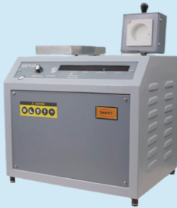
MINI + MELTING MACHINE 250 GM TO 1 KG
